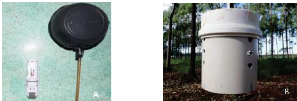
Figura 2: Equipamentos componentes da estação micrometeorológica: (A) termohigrômetro digital com datalogger; globo negro; (B) Abrigo micrometeorológico perfurado ao lado do datalogger.
