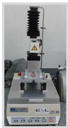
Figura 5. Texturômetro acoplado com lâmina tipo Warner Bratzler Shear.
